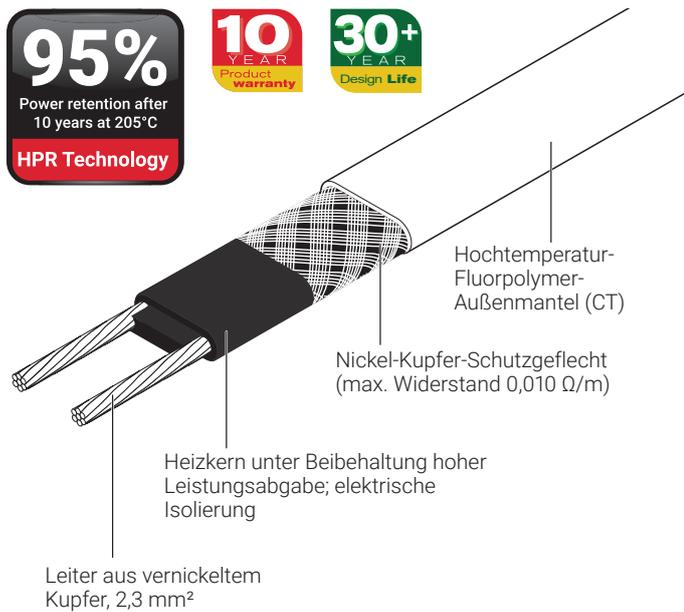
Das selbstregelnde Heizband nVent RAYCHEM HTV ist als Frostschutz oder zum Halten der Prozessstemperatur bei Rohren und Behältern mit durchgängig sehr hohen Betriebstemperaturen (205°C) ausgelegt.
