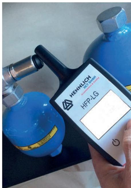
Das HFP-LG System findet seinen Einsatz bei der gasseitig Drucküberwachung bei der hydraulischen Speichertechnik - vor allem bei der regelmäßig empfohlenen Kontrolle des Vorfülldruckes. In Verbindung mit unseren vielfältigen Gasadaptern im Zubehörprogramm, kann der übliche Einsatzbedarf optimiert und die Servicezeiten minimiert werden.
