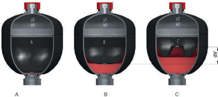
**A.** Die Membrane ist in der Vorfülldruckstellung, d.h. sie ist nur mit Stickstoff beaufschlagt. Der eingeknöpfte Teller verschließt die Ölöffnung und verhindert die Zerstörung der Membrane.
