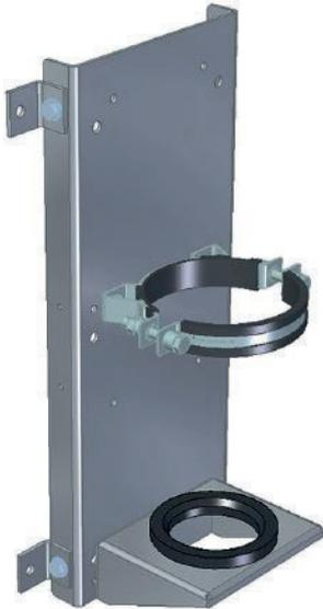
Die **HENNLICH** Befestigungssets bestehen aus der Konsole mit Gummiring und 1 oder 2 Stück Befestigungsschellen auf einer Rückwand montiert. Zusammen mit dem Speicher bildet es eine montierte Einheit zum Anschweißen oder Anschrauben an jede Konstruktion.
