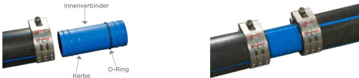
100 mm Rohr freistellen. Rohrenden leicht seitwärts biegen und den Reparatur-Verbinder bis zum O-Ring in eines der beiden Rohrenden schieben. Die Schellen bündig auf die Rohrenden schieben.
