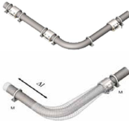
Werden STRAUB-FLEX Kupplungen verwendet, ist darauf zu achten, dass die in jedem Rohrstück stattfindende Längenänderung nicht grösser ist, als die Kompensationsfähigkeit der zur Verwendung kommenden STRAUB-FLEX Rohrkupplung.
