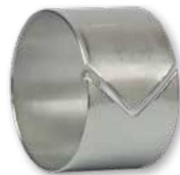
Weisen die Rohre aufgrund langer Lagerung schon Einschnürungen auf, empfehlen wir diese Einschnürstücke vor der Montage der STRAUB Stützringe abzutrennen. Geschlitzte Stützringe müssen in Richtung des aufgetragenen Pfeils montiert und rohrendenbündig verbaut werden.
