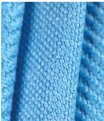
Diese Produkte bestehen aus Calcium-Silikat-Fasern und werden aus texturierten und gezwirnten Filamentgarnen hergestellt. Durch die Texturierung und zusätzliche Zwirnung werden Isolierwirkung und Abriebfestigkeit wesentlich verbessert.
