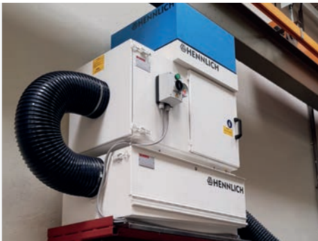
Luftreiniger von HENNLICH zur Öl-/Emulsionsnebel Absaugung
