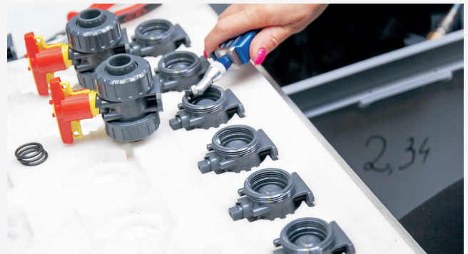
Manuelle Schmierfettauftragung mit Abnox-C1-Dosierventil.
