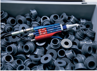
Dosierventil mit speziell für den Kunden angefertigtem Schwammaufsatz.
