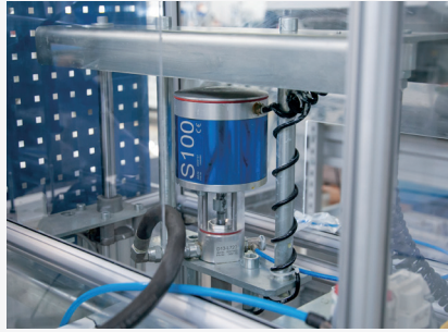
S100 Fasspumpen Station für die zuverlässige Schmierstoffversorgung der kompletten Anlage.
