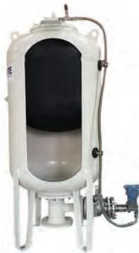
Bei Abwasserdämpfern ist im Gegensatz zu Trinkwasserdämpfern die Flüssigkeit direkt im Behälter. Eine mit Stickstoff gefüllte Blase sorgt für stabile Druckverhältnisse im System.
