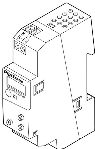
Der TCON-CSD/20 ist ein kompakter, digitaler Thermostat für die EIN-/AUS-Temperatursteuerung. Dazu wird die Temperatur mit einem Temperaturfühler gemessen und auf der LCD-Anzeige ausgegeben. Der jeweilige Zustand des Ausgangsrelais wird anhand einer LED angegeben.
