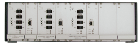
6fach Kamera-Rack mit drei Kamera-Einschüben und drei Videoservern bestückt
