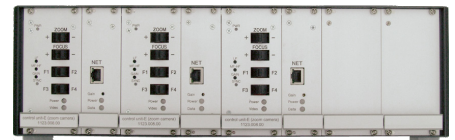
6fach Kamera-Rack mit drei Kamera-Steuer-Einschüben und drei Videosevern bestückt
