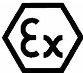
Mit dem Kennzeichen werden in der Betriebsanleitung sicherheitstechnische Hinweise zum Betreiben der Pumpen in explosionsgefährdeten Bereichen markiert.
