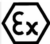
Der Betreiber hat sicherzustellen, dass bei Einsatz von Ponndorf Schlauchpumpen gemäß ATEX ausschließlich ein Gehäusedeckel aus V2A (Pos. 4) und Anschlussstülsen aus V4A (Pos. 15) verwendet werden. Die Komponenten aus Plexiglas bzw. PP sind hierfür nicht zugelassen!
